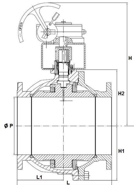
Commande par levier (ou réducteur sur demande) du DN15 au DN200, commande par réducteur sur DN250-300
