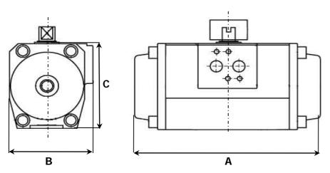
Fonctionnant sur la technologie piston-crémaillère, notre actionneur est construit avec corps et flasques en aluminium.
