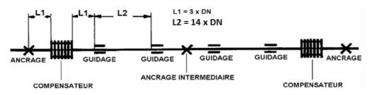
Il est indispensable de mettre en place des points d'ancrage à chaque extrémité de la tuyauterie, ils sont calculés en fonction des forces engendrées. La force de pression résultant de la section du soufflet et de la pression de service peut provoquer un déplacement de la tuyauterie, l'élongation du soufflet et peut aller jusqu'à la rupture.
