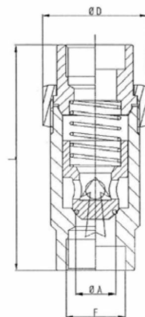
**Construction :** Clapet à bille de type Monobloc, Multi-positions
