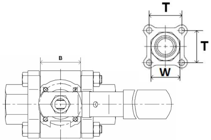
Modèle Taraudé : BSP-NPT
